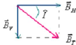
L'angle entre  $\vec{B}_T$  et  $\vec{B}_V$  s'appelle l'angle d'inclinaison  $I$ .
