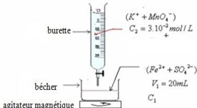
On continue à ajouter la une solution de permanganate de potassium jusqu'au point d'équivalence qui correspond au début de l'apparition de la couleur violette dans le bêcher et on indique le volume ajouté  $V_{éq} = 13,3 \text{ mL}$ .
