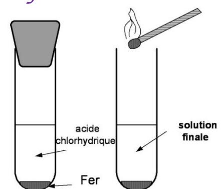
Manipulation 2 : Boucher le **tube** avec un **bouchon** adapté, attendre quelques instants pour que le **dégagement de gaz** soit **suffisant**, puis enlever le **bouchon** et approcher une **allumette enflammée** de l'**ouverture du tube** légèrement incliné.
