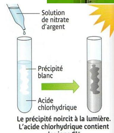
Conclusion : L'**acide chlorhydrique** contient des **ions hydrogène**  $H_{(aq)}^+$  et des **ions chlorure**  $Cl_{(aq)}^-$  en **solution** dans l'**eau**, de **formule chimique**  $(H_{(aq)}^+ + Cl_{(aq)}^-)$  .
