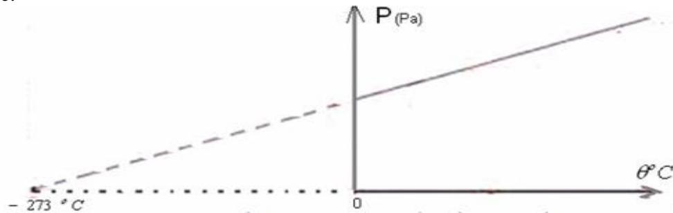
En prolongeant la courbe jusqu'à ce qu'elle se coupe avec l'axe de la température centésimale, on constate que la pression s'annule (théoriquement) lorsque la température est -273°C.
