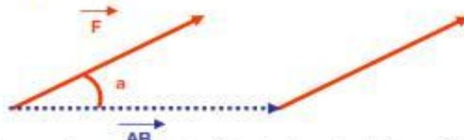
Si le trajet AB fait un angle  $\alpha$  avec la droite d'action de la force  $\vec{F}$
