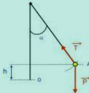
Si l'on considère que l'énergie potentielle est comptée à partir du point O, c'est-à-dire la position la plus stable de la bille.
