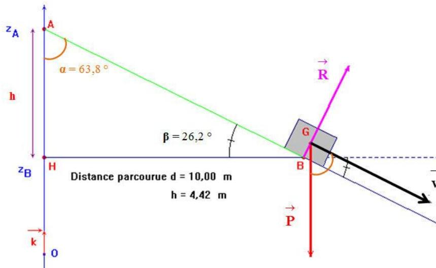
Le travail de la force  $\vec{R}$ , réaction du support, sur le même trajet AB est nul car la réaction du support est perpendiculaire au support.
