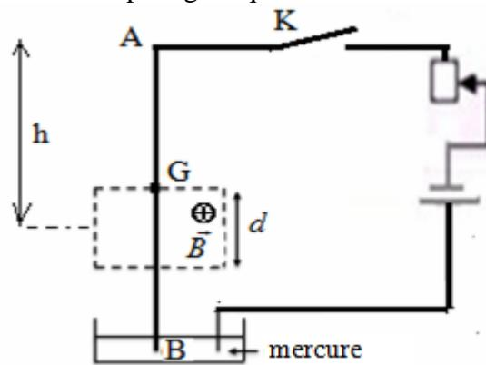
Lorsqu'on ferme le circuit, un courant électrique continu d'intensité  $I=10\text{A}$  passe dans la tige du point B au point A et elle s'incline d'un angle  $\alpha = 40^\circ$  puis elle se stabilise.
