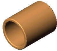
Palier lisse monté serré
