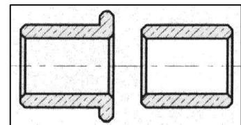
Les coussinets sont réalisés à partir de différents matériaux : bronze, matières plastiques (nylon, téflon). Ils peuvent être utilisés à sec ou lubrifiés. Il existe d'ailleurs des coussinets autolubrifiants imprégnés d'huile dans leur structure, ayant les caractéristiques suivantes :
