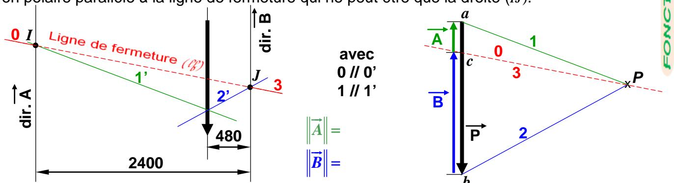
Les côtés extrêmes (0' et 3') du funiculaire sont confondus avec la ligne de fermeture ( $IJ$ ). Par correspondance, les rayons polaires (0 et 3) sont confondus avec  $P_c$ .
