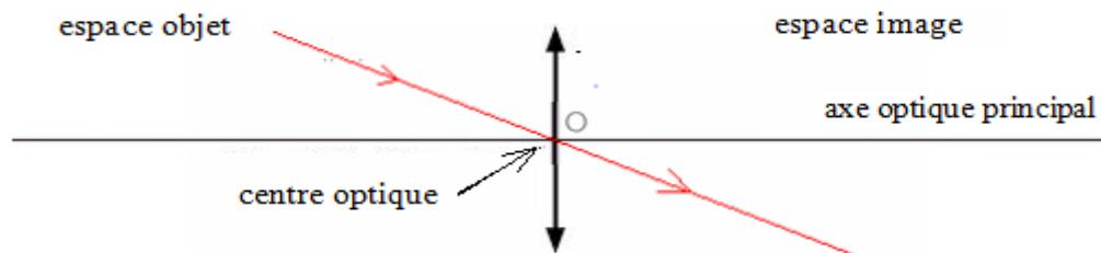
Le centre optique de la lentille est le point d'intersection de la lentille avec son axe optique principal.
