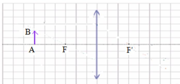
Pour construire l'image d'un objet AB , donnée par la lentille il suffit de tracer les rayons issus de B passant par O ,F et F'.
