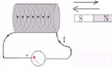
Dans cette expérience l'énergie mécanique est transformée en énergie électrique.
