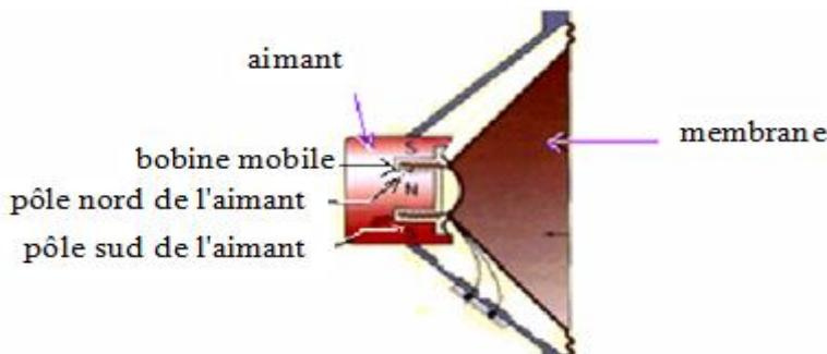
Lorsqu'un courant électrique d'intensité  $I$  passe dans la bobine, chacune de ses spires est soumise à la force de Laplace qui la met en mouvement ce qui provoque le mouvement de membrane qui agit sur la couche d'air qui l'entoure et elle produit un son qui a la même fréquence que celle du courant électrique.
