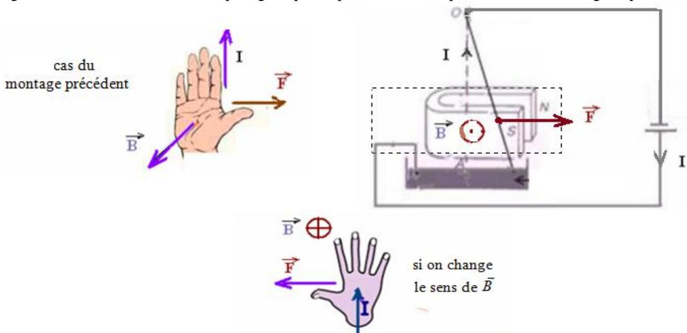
Intensité : l'intensité de la force de Laplace  $F = B.I.\ell \sin \alpha$  avec  $\alpha = (\vec{B}, \vec{\ell})$
