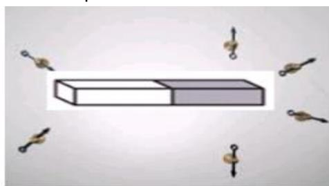
L'aimant provoque une modification des propriétés de l'espace qui l'entoure car il crée autour de lui un champ magnétique. Tout point du champ magnétique est caractérisé par un vecteur champ magnétique  $\vec{B}$ .
