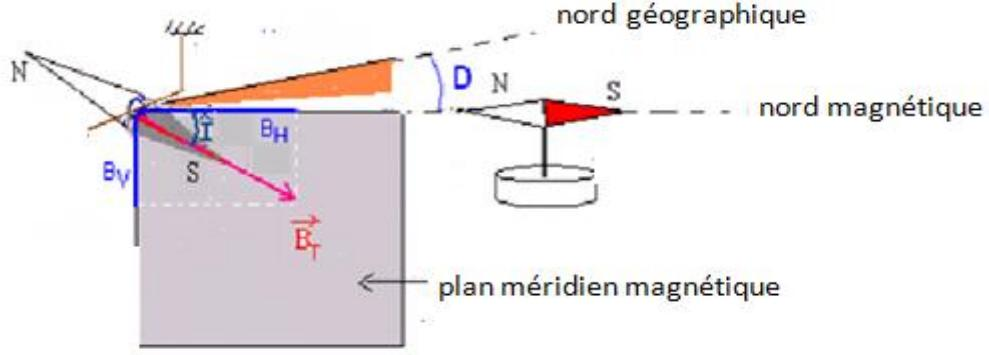
L'aiguille aimantée placée sur un axe vertical prend toujours la direction de la composante horizontale du champ magnétique terrestre  $\vec{B}_H$ .
