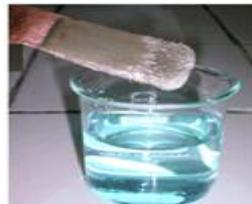
On observe après quelques minutes un dépôt gris sur la partie immergée de la plaque et la solution prend une couleur bleue.
