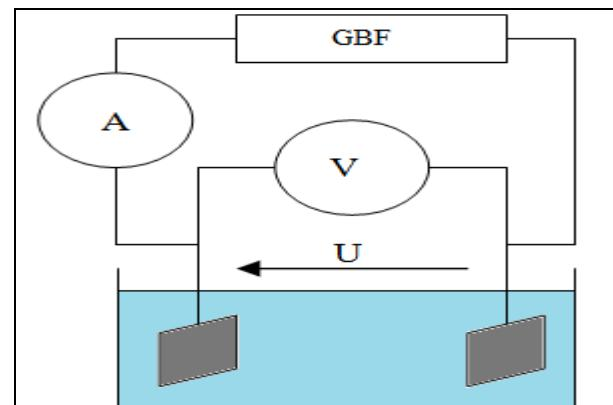
L'ensemble générateur, ampèremètre et voltmètre peut être réuni dans un appareil appelé **conductimètre**.
