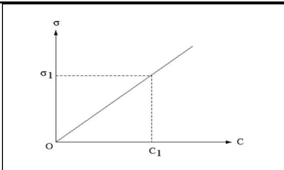
Cette courbe d'étalonnage permet ensuite de retrouver la concentration inconnue de la solution à doser à partir de la mesure de la conductance
