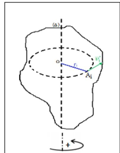
$J_\Delta$  : s'appelle le moment d'inertie du solide par rapport à l'axe de rotation ( $\Delta$ ) . Il dépend de la répartition de la masse autour de l'axe de rotation.
