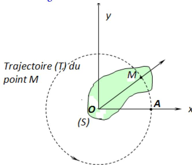
Lors d'un mouvement de rotation, l'angle parcouru (balayé) par tous les points du solide pendant le même intervalle de temps est le même. On l'appelle angle de rotation de solide et on le note  $\theta$  (téta) et son unité est le radian (rad).
