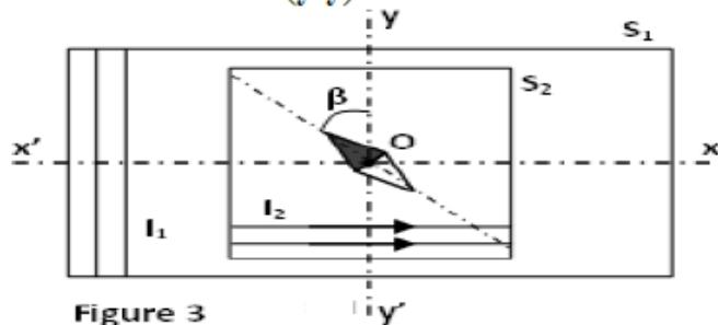
Lorsque ( $S_2$ ) est parcouru par un courant d'intensité  $I_2$ , l'aiguille aimantée, toujours placée en  $O$ , dévie d'un angle  $\beta = 45^\circ$  par rapport au méridien (figure 3).
