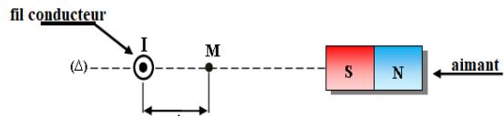
2. Représenter sur la figure (sans échelle) au point M :  $\vec{B}_1$  le vecteur du champ magnétique créé par le courant électrique traversant le fil conducteur,  $\vec{B}_2$  le vecteur du champ magnétique créé par l'aimant, et  $\vec{B}_T$  le vecteur du champ magnétique total au point M. (1.5pt)
