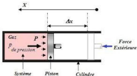
1. Sachant que la pression externe est  $P_0 = 10^5 \text{ Pa}$ , calculer la pression de l'air contenu dans le cylindre. **1pt**
