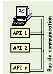
Il va sans dire que le **Bus** est partagé et doit donc connaître un "**arbitrage**", en effet, d'après la structure physique du réseau (**norme RS485**), il ne peut y avoir qu'un seul élément qui émet sur le bus, le reste écoute, d'où la nécessité de s'accorder sur des règles de communication, qu'on appelle **protocole**.
