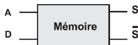
C'est une bascule RS dont l'entrée Set sert pour l'activation et l'entrée Reset sert pour la désactivation.
