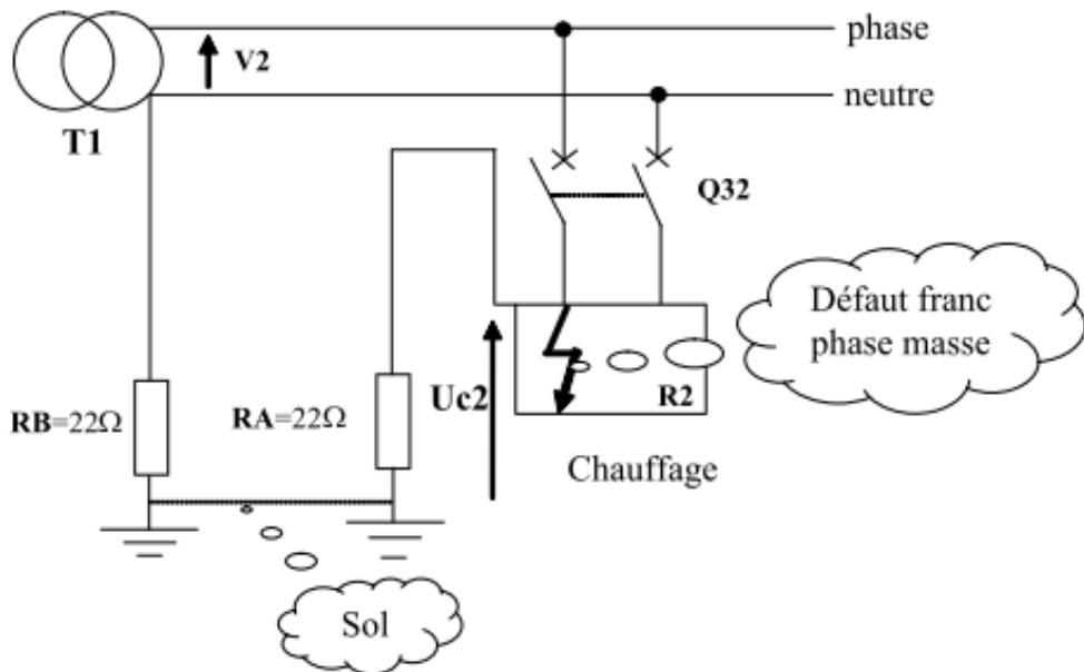
1/ Flécher sur le schéma le parcours du courant de défaut  $i_d$  si  $Q32$  est fermé. Établir l'expression littérale du courant de défaut  $I_d$  :
