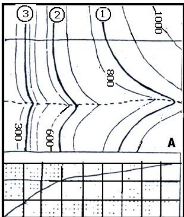
Parallélisme entre les courbes de niveaux et les limites d'affleurement 1 , 2 et 3 :
