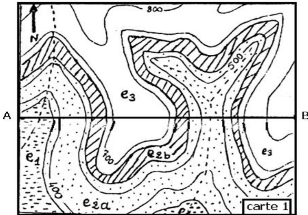
Parallélisme entre les courbes de niveaux et les limites d'affleurement des différentes couches, les couches e1 , e2 et e3 sont horizontales .
