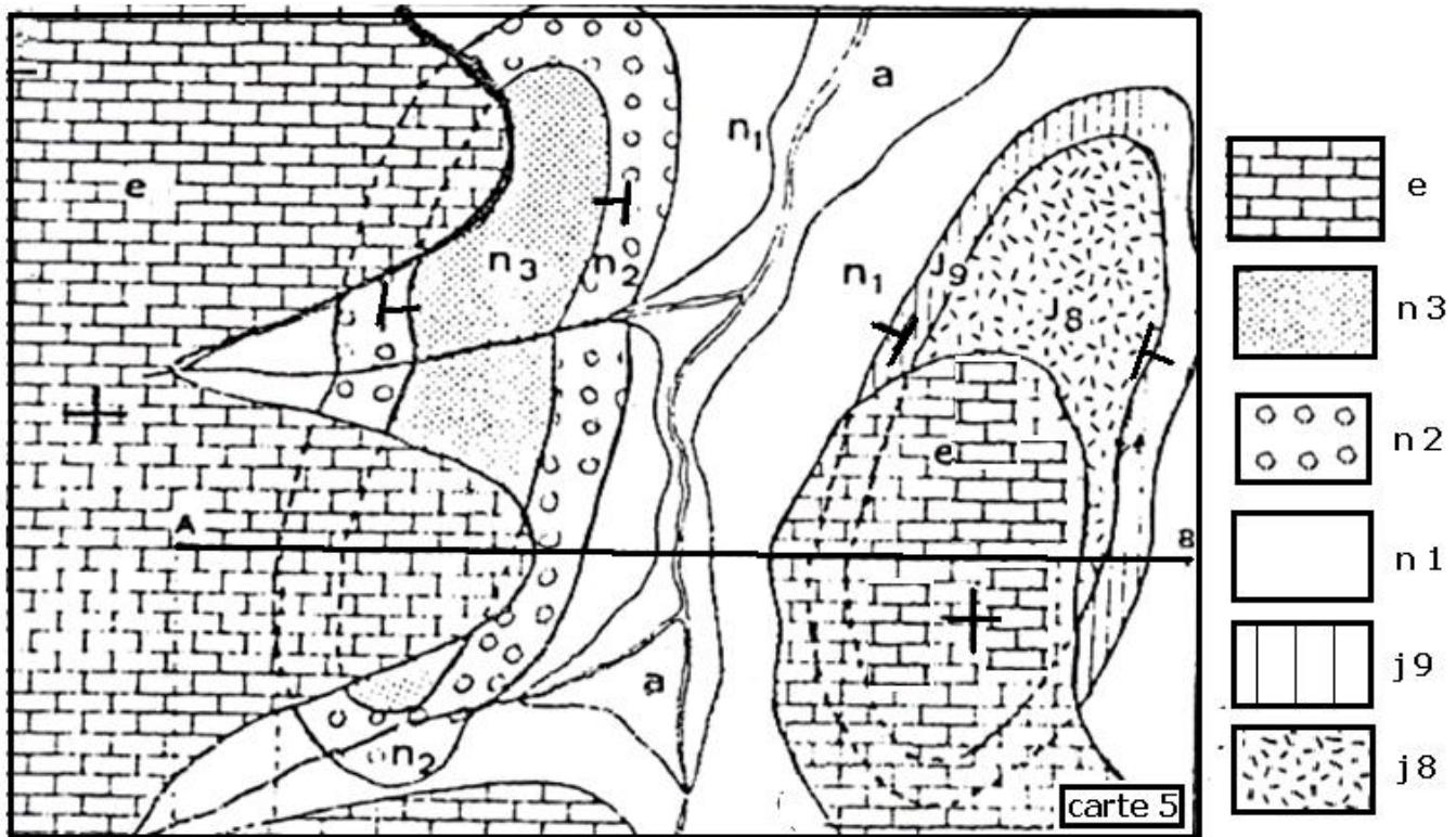
Les couches j et n les plus anciennes sont plissées , j en anticlinal n en synclinal
