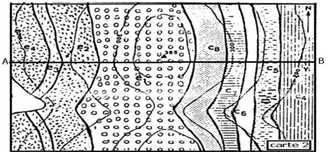
Les courbes de niveaux et les limites d'affleurements forment des V qui interfèrent , les V d'affleurement d'ouverture moyenne indiquent l'ouest, les couches C et e sont moyennement inclinées vers le sud ouest .
