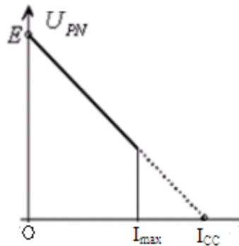
(Généralement on a  $I_{max} < I_{CC}$ , courant de court -circuit
