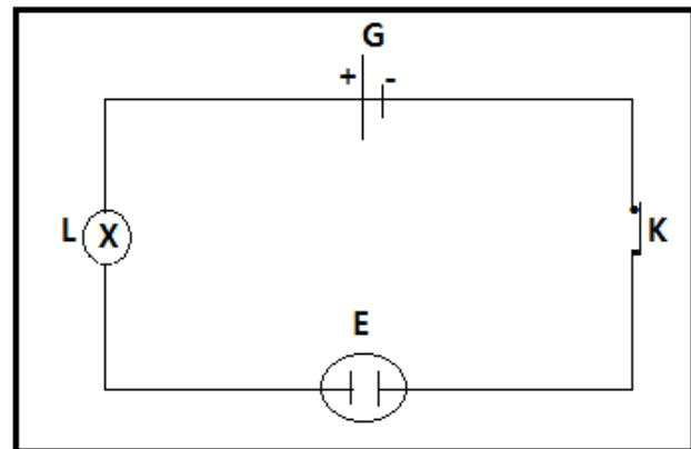
La lampe s'allume et s'échauffe. Elle reçoit de l'énergie électrique du générateur. Elle la convertit en énergie rayonnante et en énergie thermique.
