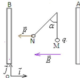
En appliquant une d.d.p.  $U_{AB} > 0$  entre A et B, il apparaît entre les plaques un champ électrique uniforme dont le vecteur  $\vec{E}$  est uniforme qui a le même sens que les potentielles décroissants donc la boule est soumise à une force électrostatique  $\vec{F} = q\vec{E}$  qui a le même sens que  $\vec{E}$  car  $q > 0$  et elle se déplace de M à N provoquant l'inclinaison du pendule de l'angle  $\alpha$ .
