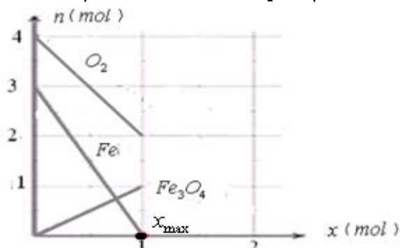
On ne doit pas prolonger les segments de droite après  $x_{\max}$  car c'est la valeur maximale de l'avancement (lorsque  $x=x_{\max}$ , la composition du mélange devient constante).
