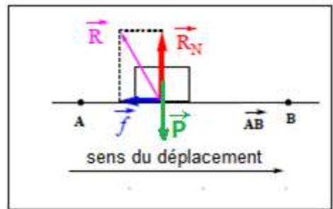
$\vec{R}_N$  : Réaction normale du support et  $\vec{f}$  : force de frottement
