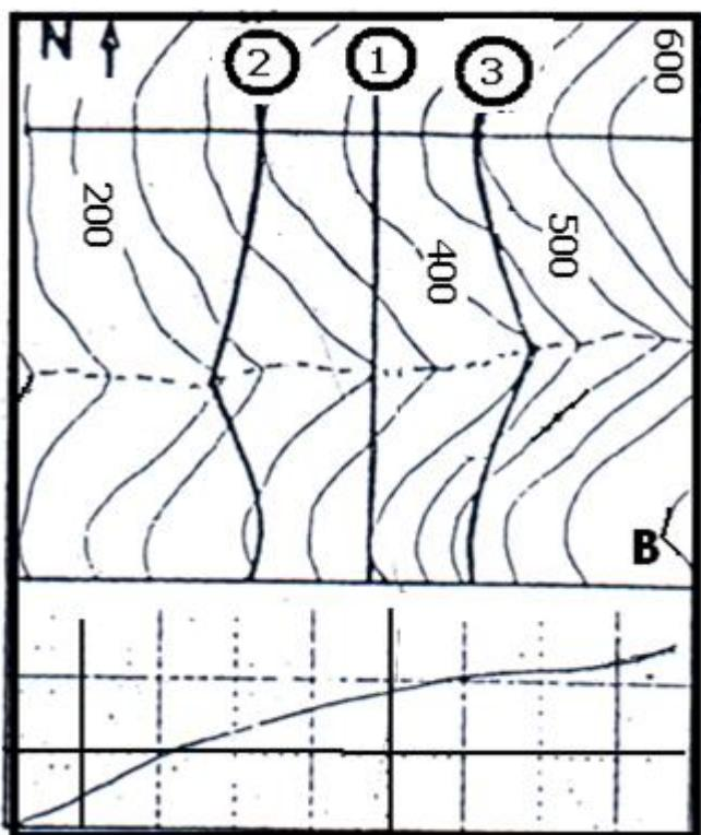
Intersection entre V des courbes de niveaux et les limites d'affleurement :
