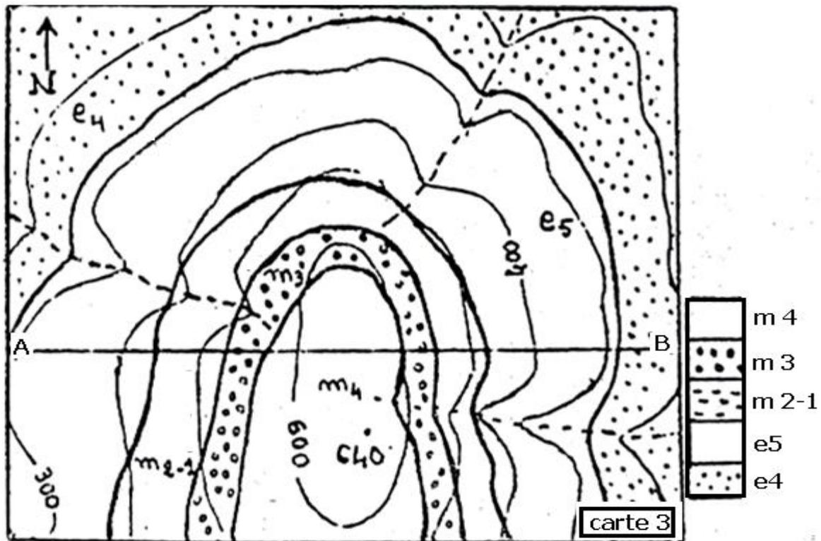
Les couches m et e sont imbriquées .cette répartition signifie qu'elles sont pliées pour déterminer le type de plie on détermine l'âge relatif de la couche centrale , m 4 est la plus récente ,les couches donc forment un plie synclinal .
