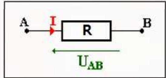
Le conducteur ohmique transforme toute l'énergie électrique qu'il reçoit, en énergie thermique.
