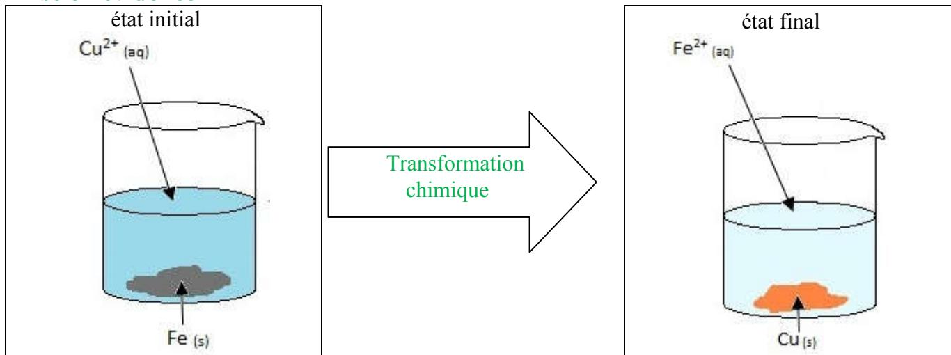
Un dépôt rouge de cuivre se forme sur le poudre de fer. La solution, initialement bleue par la présence des ions cuivre (II), prend la teinte verte pâle des ions fer (II)
